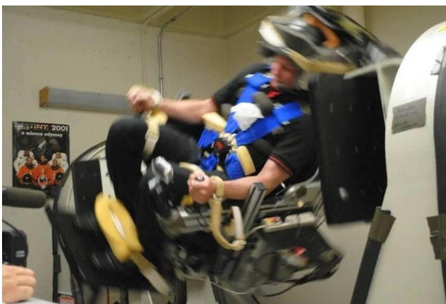
Figura 3.3 Sillones capaces de realizar rotaciones en distintas velocidades y angulaciones son utilizados para producir habitación a estos movimientos en astronautas y pilotos. Imagen: Quantum Astronaut.
