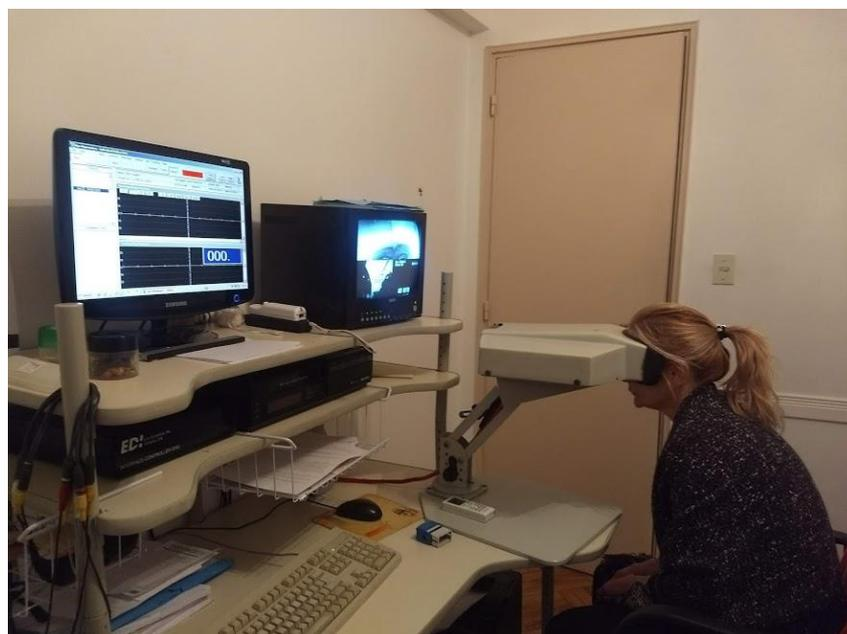
**Figura:** Módulo oculomotor utilizado en VNG.
